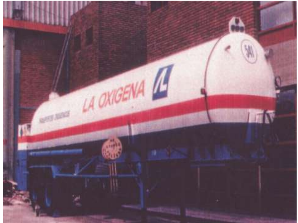
Tanque de Transporte Capacidad 18.000 Lt. De Oxígeno Líquido Aislación: Perlita con vacío intersticial 75 mm de Hg
